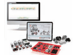
専用ソフトを利用し、アイコンを並べるだけでプログラミングができる。細やかな条件の指定も可能。
