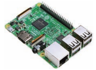
Raspberry Piの本体。モニターはHDMI接続できる家庭用テレビでもOKだ。
