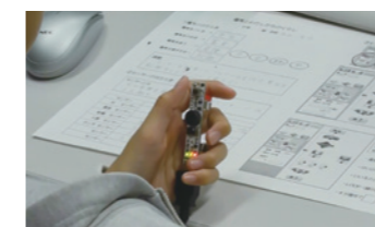
▲「計測制御プログラマー」の基板には、照度センサー、温度センサー、LED、ブザーなどが組み込まれている。
